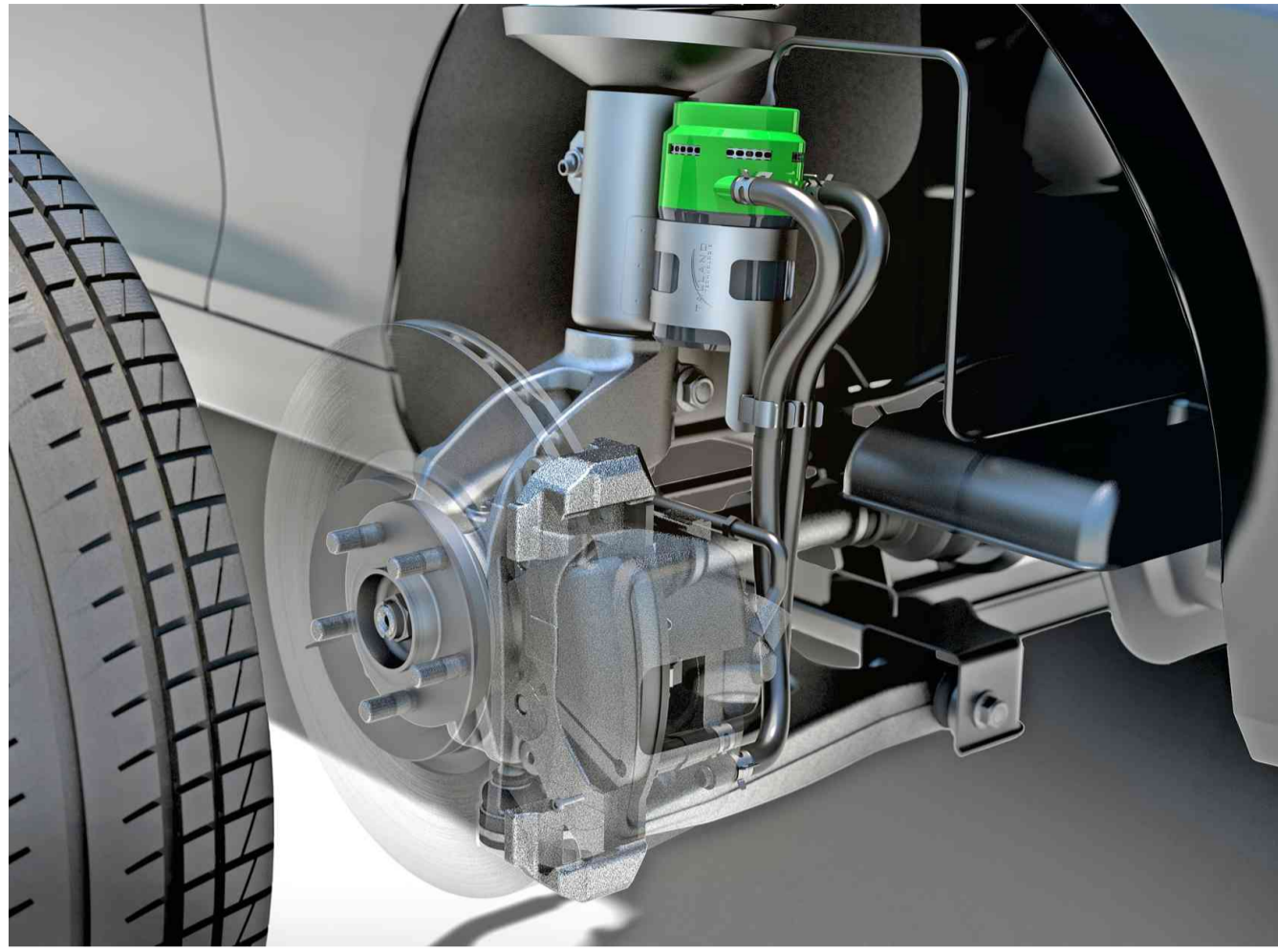
Ausgebremst: Über eine Nut im Bremsbelag saugt Tamic Feinstaub ab und sammelt ihn in einem Filter. Illustration Tallano Technologie
